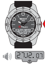
Milloin tahansa: poistuminen alavalikosta – paluu päivämäärän näyttöön
