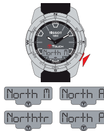
Paikallisen ilmaston säätö: T = lauhkea M = välimerellinen A = kuiva TR = trooppinen P = napa
