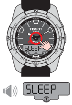
Siirtyminen automaattisesti valmiustilaan 5 sekunnin jälkeen Äänimerkki joka sekunnilla
