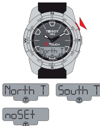
Pallonpuoliskon valinta: North = Pohjoine, South = Eteläinen not set = ei asetettu
